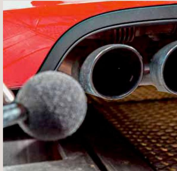
Die Klangentwicklung an der Abgasmündung wird mit dem Mikro aufgenommen. Aus der Aufnahme entstehen digitale Signale, die zum späteren Komponieren als Frequenzgänge sichtbar gemacht werden.
