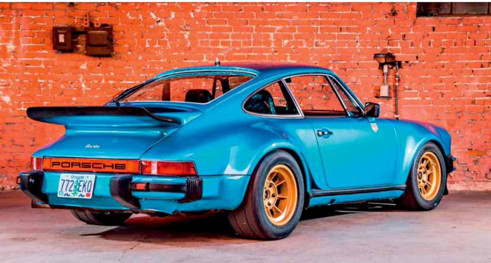
**Extrem-Elfer: Den aus der Schweiz stammenden 911 Turbo von 1976 inszeniert Walker wie sich selbst: auffällig, abseits der Norm und schnell unterwegs. Ein größerer Turbolader und goldfarbene PAG-Räder unterstützen den dramatischen Auftritt.**
