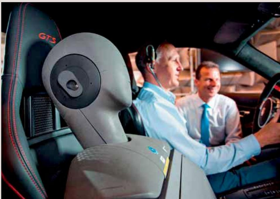
Der Dummy hört alles bis in die feinste Nuance. Er wird als Beifahrer platziert und nimmt über seine „Ohren“ alle Geräusche auf, die auch der echte Beifahrer hört.
