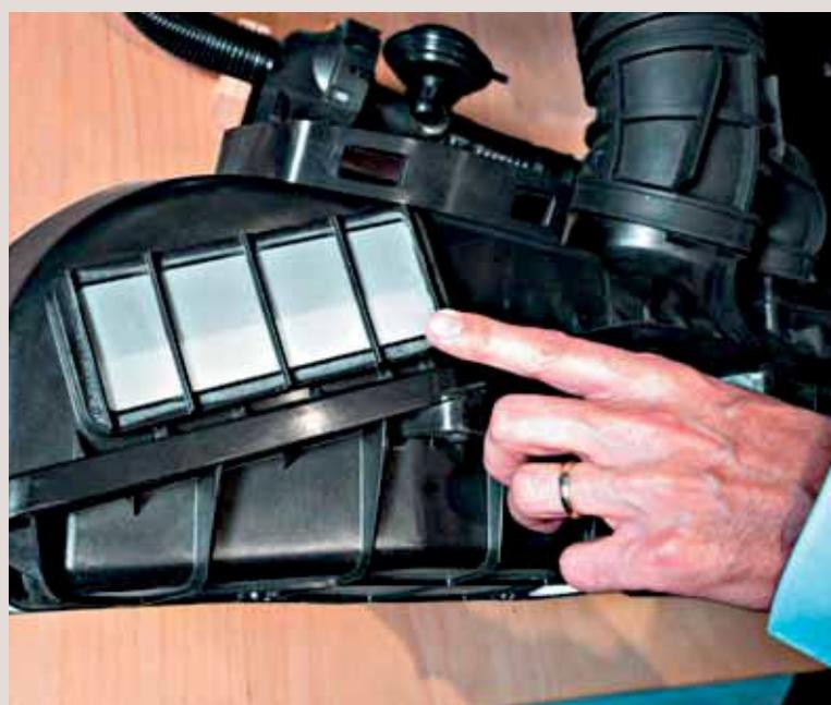
Von der Verbindung zwischen Luftfiltergehäuse und Luftmengenmesser geht eine Leitung ab, die bis an die Hutablage geführt wird, wo sie die Insassen mit dem gewünschten Wohlklang versorgt.
